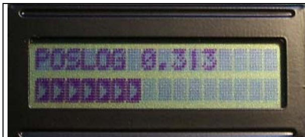
Abbildung 70: Willkommensbildschirm Anzahl der Systemstarts und Softwareversion des Loggers
