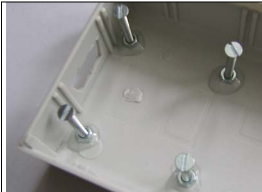
Abbildung 23: Positionierung der Muttern
