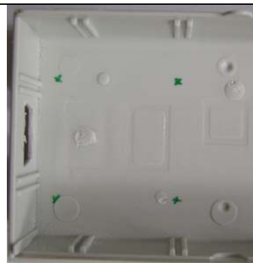
Abbildung 20: Markierung der Klebepunkte
