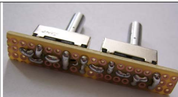
Abbildung 36: Angelötete Schalter
