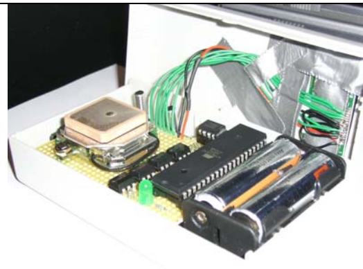
Abbildung 64: Endmontage des Loggers
