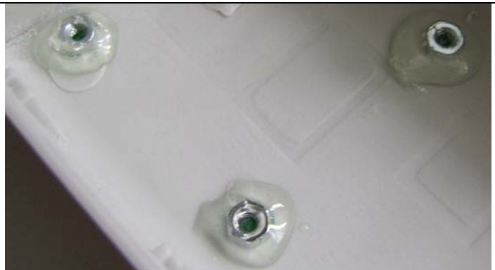
Abbildung 24: Fertig geklebte Muttern
