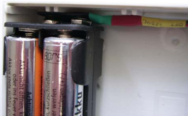
Abbildung 40: Batterieclip auf Batteriehalter
