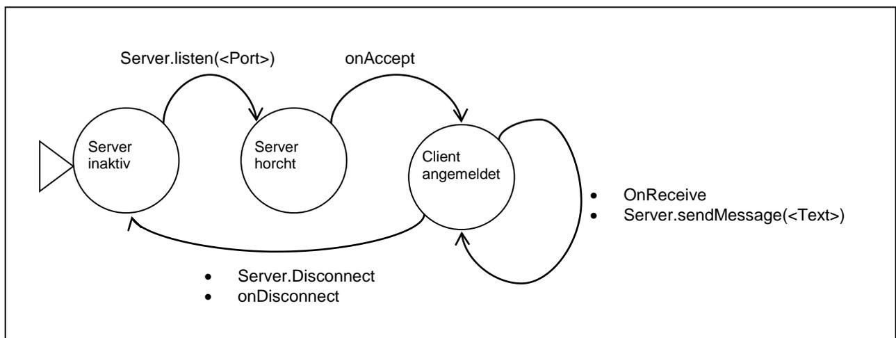
Beim Aufbau einer Verbindung, wenn sich ein Client anmeldet, wird das Ereignis „onAccept“ ausgelöst:
