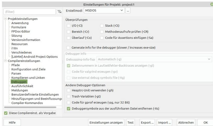
Den Haken bei Generate info for debugger (slower/increase exe-size) entfernen. Bei Debuggersymbole aus der ausführbaren Datei entfernen (-Xs)
